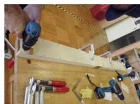
図30 木ネジの締め付け
