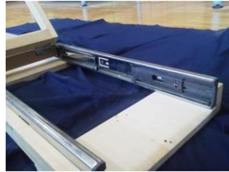
図12 スライドレール装着後の外土台
