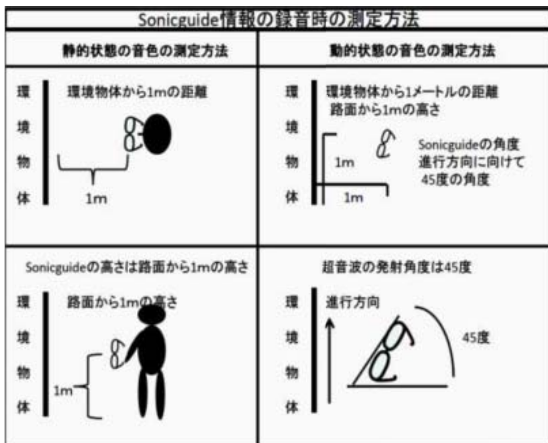
図8 Sonic-guide TM の音色分析に用いた録音方法
