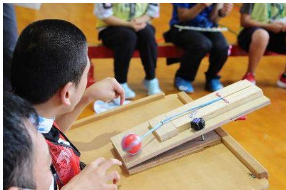
図7 ゴムのついたボールを引き、離れたゴムの力でピンをとばす補助具 (網走養護学校)
